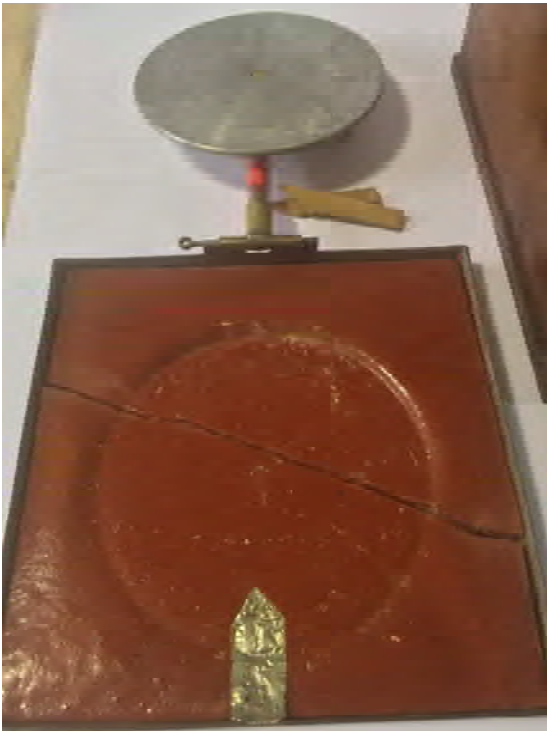
L'elettroforo con la base fratturata
