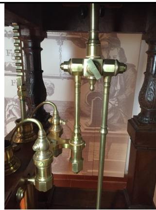
Fig. 5. Sinistra: particolare del telaio sul ripiano superiore che deve trattenere saldamente il recipiente quando la pompa comprime l'aria al suo interno. Destra: rubinetto a due vie che apre la comunicazione con il tubo lungo (la pompa rarefa l'aria) o con il tubo corto (la pompa comprime l'aria)
