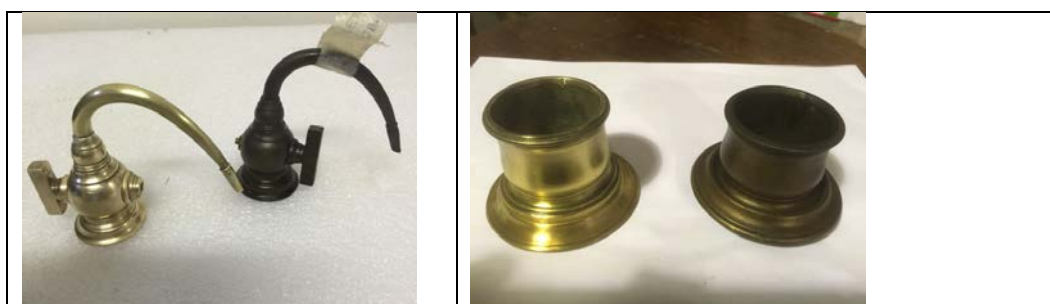
Fig. 7. Alcuni elementi d'ottone prima della pulizia e della verniciature (a destra nelle foto) e dopo (a sinistra nelle foto)
