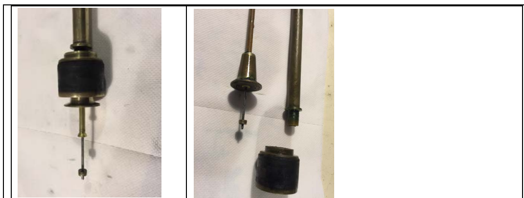
Fig. 3. Pistone della pompa Albrici con la valvola azionata meccanicamente
